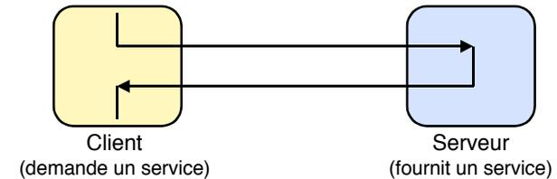
Le schéma **client-serveur** a été vu en TD pour des processus sur une même machine. Ce schéma se transpose à un réseau, où les processus client et serveur sont sur des machines différentes.
